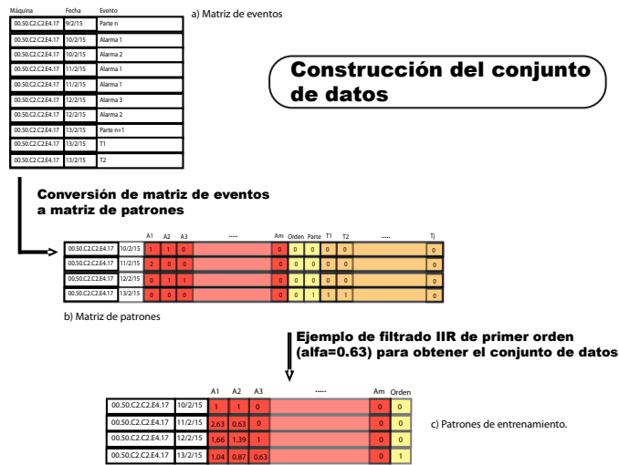
Fig. 1. Esquema de construcción del conjunto de datos para desarrollar el sistema experto
